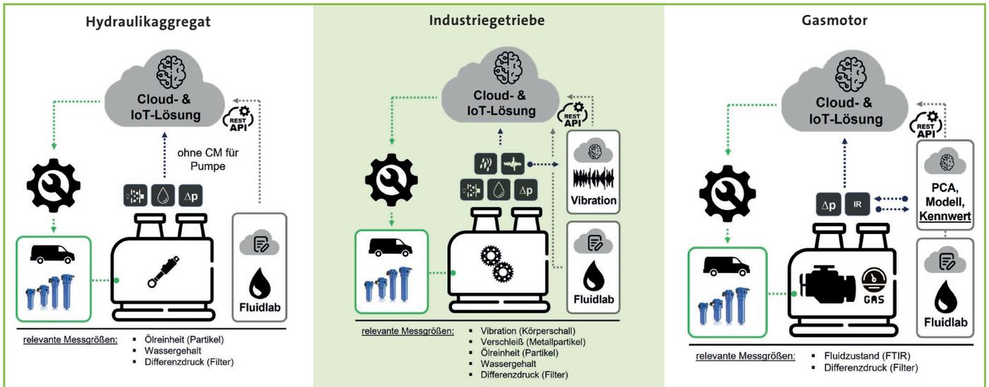
04 Beispiele IoT-gestützter Zustandsüberwachungskonzepte
