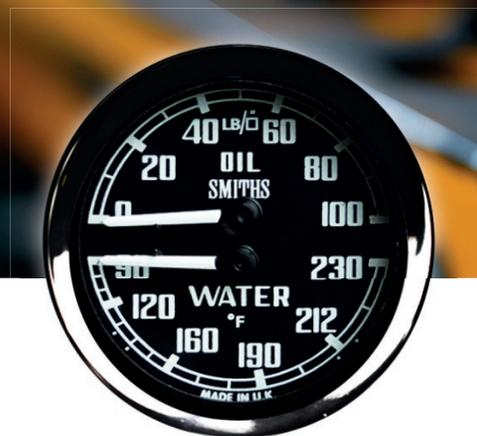
**01** Kombiinstrument zur Anzeige von Öldruck und Kühlwassertemperatur in einem Auto der Marke MG
