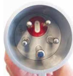
5-poliger Stecker für den Drehstrommotor
