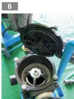
6 Die korrekte Positionierung der Elementaufnahme/der Feder/des Deckels und den Filterverschluss kontrollieren
