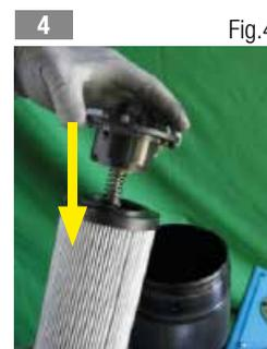
Die Endkappe mit Bypass (Abb. 4) oder die eventuell gewählte Blind-Endkappe (Abb. 5) in das Filterelement einsetzen
