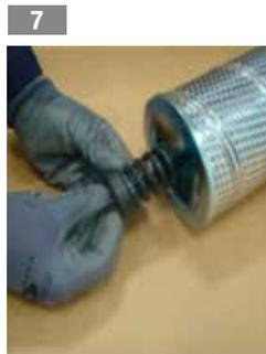
7 Die Bypass-Feder einsetzen
