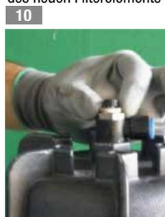
10 Das Entlüftungsventil schließen
