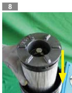
8 Das neue Filterelement einsetzen
