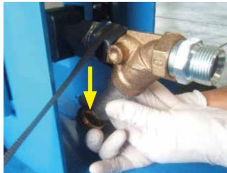
Die Mutter abschrauben und das Filterelement heraus ziehen.
