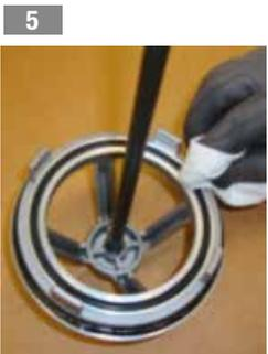
5 Die Elementaufnahme des Filterelements säubern
