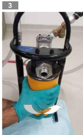
3 Die Filterpatrone einschrauben, bis die Dichtung den Filterkopf berührt, und dann noch eine halbe Umdrehung vornehmen
