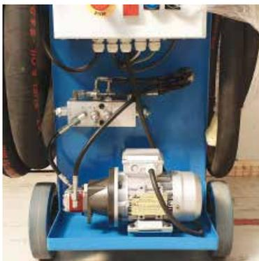
Gruppe Motor/Pumpe und Druckentlastungsventil für die Verwendung des Partikelzählers
