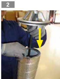
2 Die Elementaufnahme in das Filterelement einschieben
