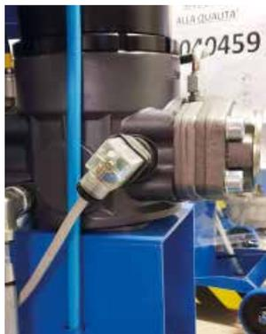
Ausführung mit optischer/ elektrischer Anzeige Fig.20
