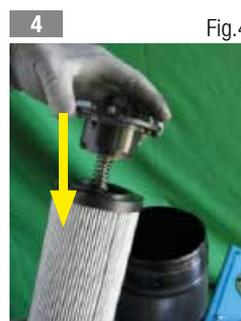
4 Die Endkappe mit Bypass (Abb. 4) oder die eventuell gewählte Blind-Endkappe (Abb. 5) in das Filterelement einsetzen
