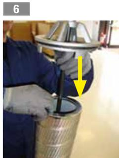
6 Die korrekte Positionierung der Elementaufnahme/der Feder/des Deckels u. den Filterverschluss kontrollieren
