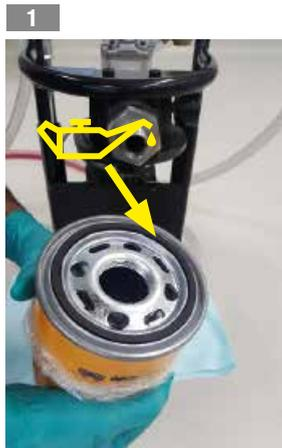
1 Die Dichtung der Filterpatrone mit dem im Gebrauch befindlichen Fluid schmieren
