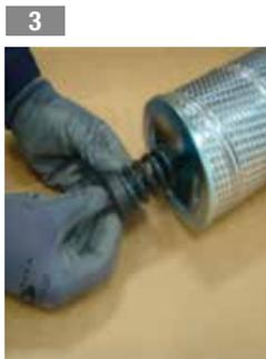
3 Die Bypass-Feder einsetzen
