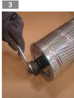
3 Die Mutter der Bypass-Feder losschrauben
