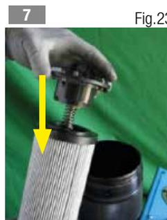
7 Die Endkappe mit Bypass (Abb. 23) bzw. die eventuell verwendete Blind-Endkappe (Abb. 24) des neuen Filterelements einsetzen
