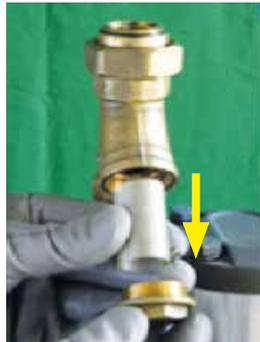
Die Mutter abschrauben und das Filterelement heraus ziehen.
