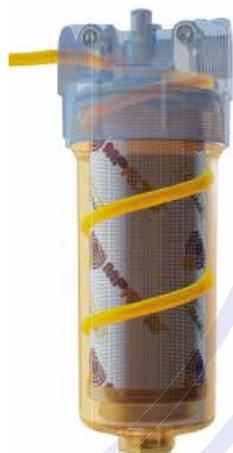
Hoher Wirkungsgrad dank der Spiralgeometrie: Das Öl tritt spiralförmig in den Filtertopf ein und strömt so optimal durch das Filterelement. Dadurch werden ein geringerer Druckverlust und eine längere Standzeit erreicht.
