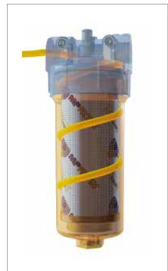
**Hoher Volumenstrom,** bedingt durch die spezielle Innenkontur des Kopfes: das Öl strömt spiralförmig in den Filtertopf und sorgt durch die laminare Strömung am Filterelement für weniger Druckverlust und ein verlängertes Elementwechselintervall.
