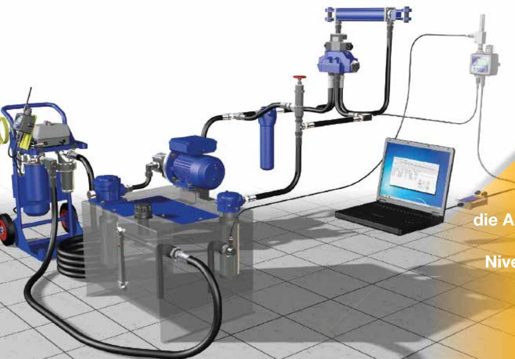
Um die Hydraulikflüssigkeit sauber zu halten, ist die Nutzung von Filtern, die die Anlagenverschmutzung auf einem verträglichen Niveau halten, unumgänglich.
