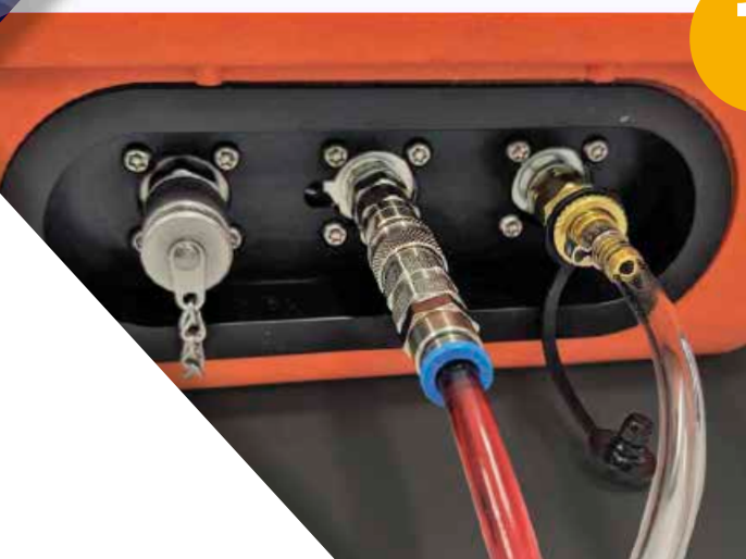
Sauganschluss und Auslass im Betrieb.
