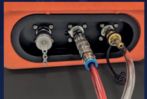
Sauganschluss und Auslass im Betrieb.
